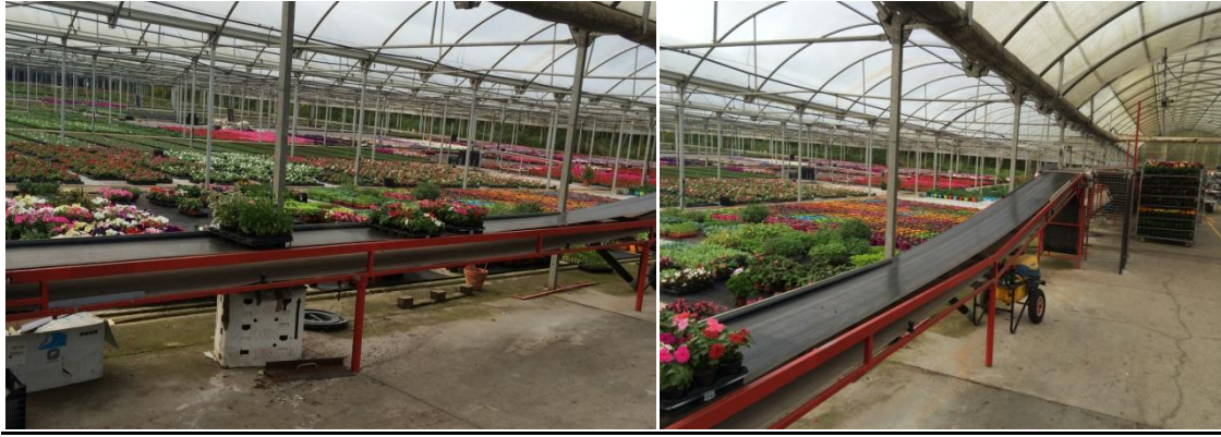
Figura 12 e 13 – Esteiras transportadoras e área preparação de pedidos automática com leitores de código de barras em Santiago de Compostela - Espanha
