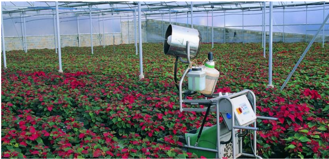
Figura 11 – Sistema para tratamentos fitossanitários UBV modelo NEBULA da empresa Conic System: http://www.conic-system.com/
