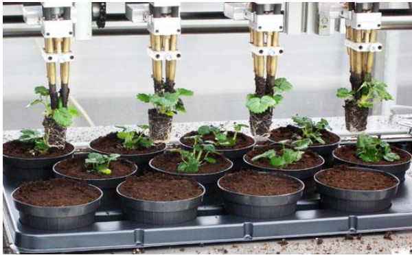
Figuras 3 e 4 – Máquinas para plantação mecanizada. Detalhe do sistema de pinças do Robô plantador XT 600 da empresa Tea: www.cermosan.com
