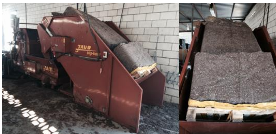
Figura 2 – Sistema de Big Bale para substratos e máquina para preparação e enchimento dos vasos
